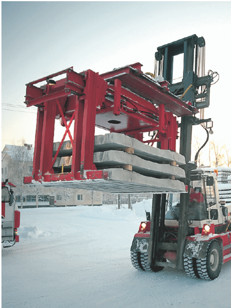
Tarrain betonisille ratapölkyille trukilla nostettaessa
