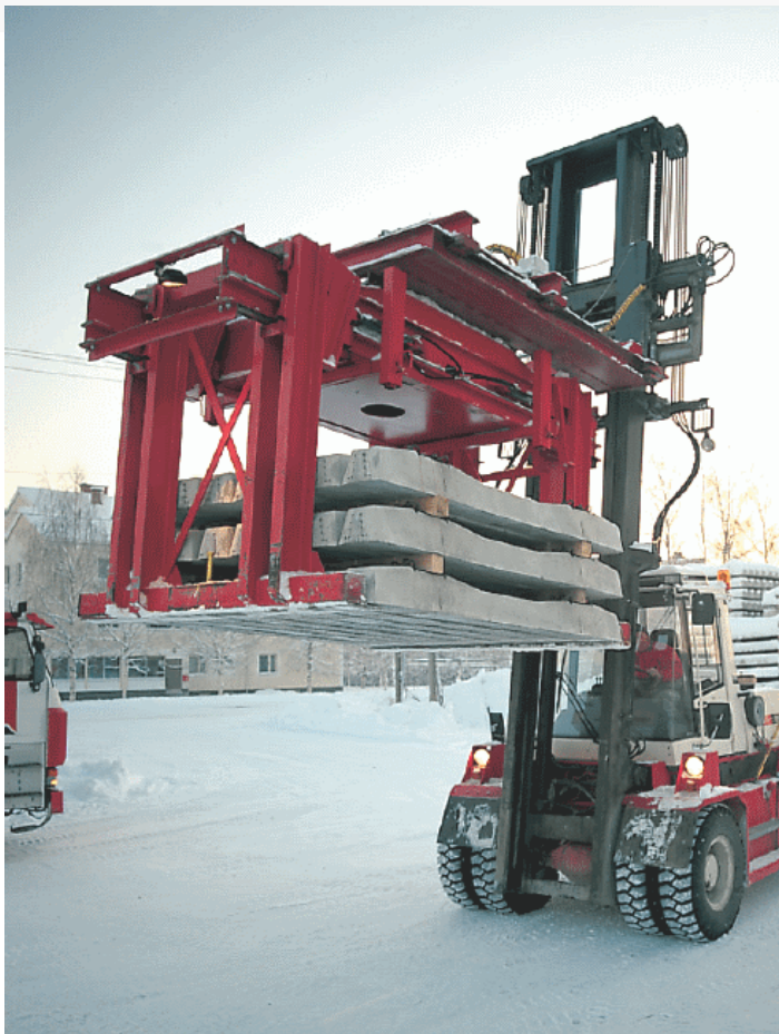
Hydraulitoiminen 9 tonnin trukkitarrain betonisten ratapölkkyjen lastauksessa
